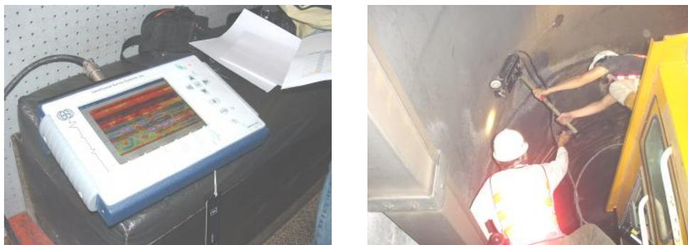
圖 49 GPR 主機及現場施測照片
