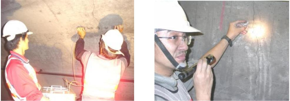
圖 54 裂縫深度及寬度檢測實況
