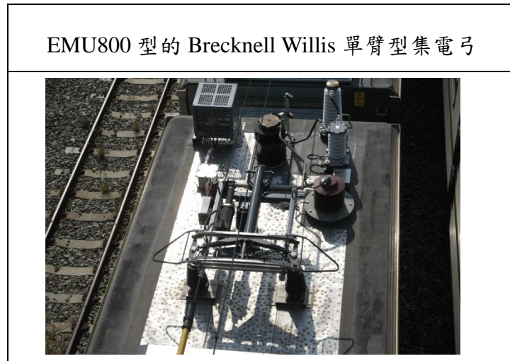
圖 2 EMU800 型的 Brecknell Willis 單臂型集電弓
