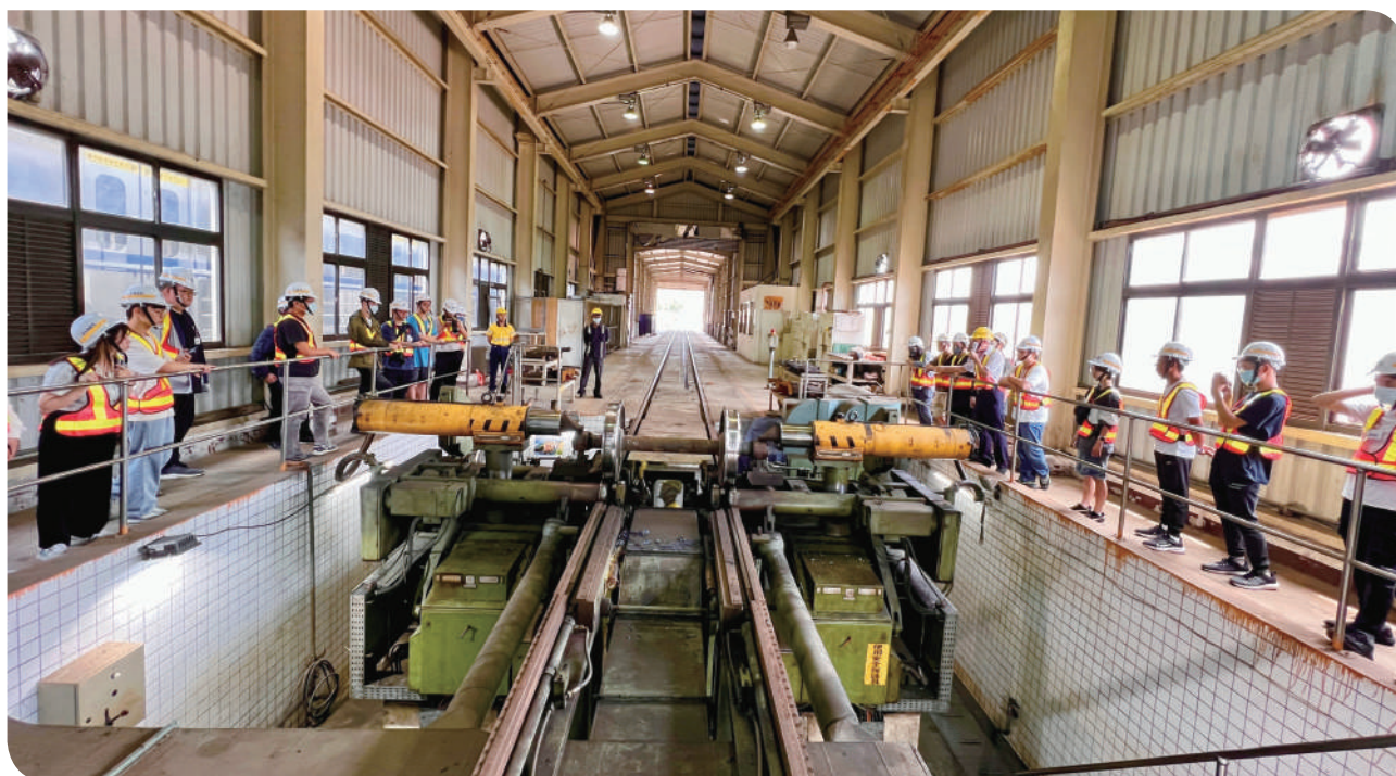
▲地下車輪床車輪銼削作業
